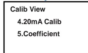
➤ 通过 ▼ 键移动光标选择 “4.20mA Calib ”项, 按 ENT 键进入; 用万用表测电流输出端 MA1+ 、MA1- , 按 ENT 键进入;
